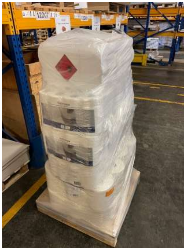
Slika 199: Primer slabega pakiranja (Lastni vir)
