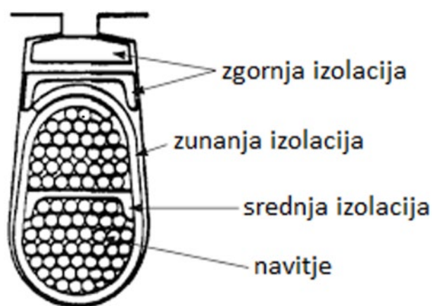
Slika 4: Primer dvojnega navitja (Lastni vir)
