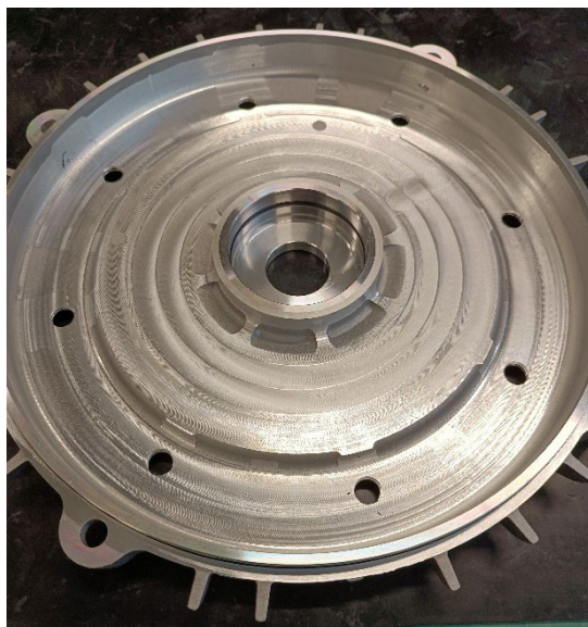
Slika 16: Prirobnica po končani obdelavi (Lastni vir)
