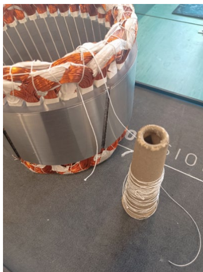
Slika 12: Povijanje z vrvjo (Lastni vir)
