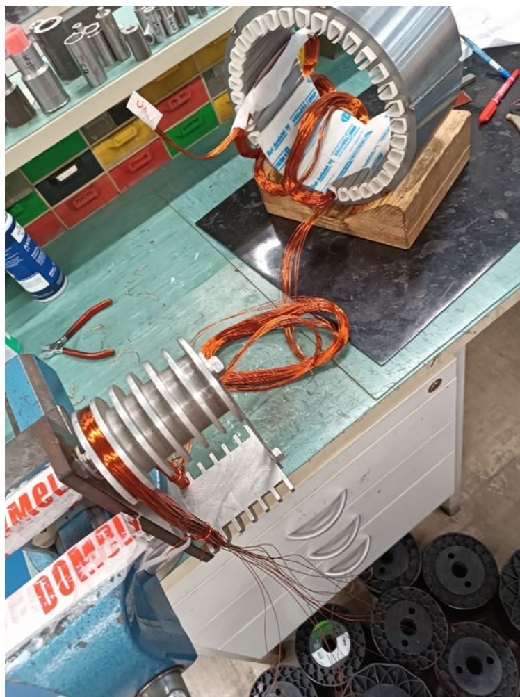
Slika 10: Navijanje tuljav in vstavljanje v stator (Lastni vir)
