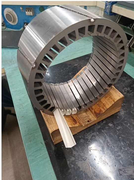
Slika 9: Vstavljanje izolacije v stator (Lastni vir)
