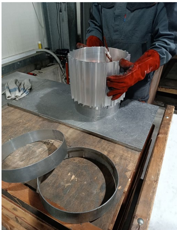
Slika 14: Vstavljanje aluminijastega ohišja na paket (Lastni vir)
