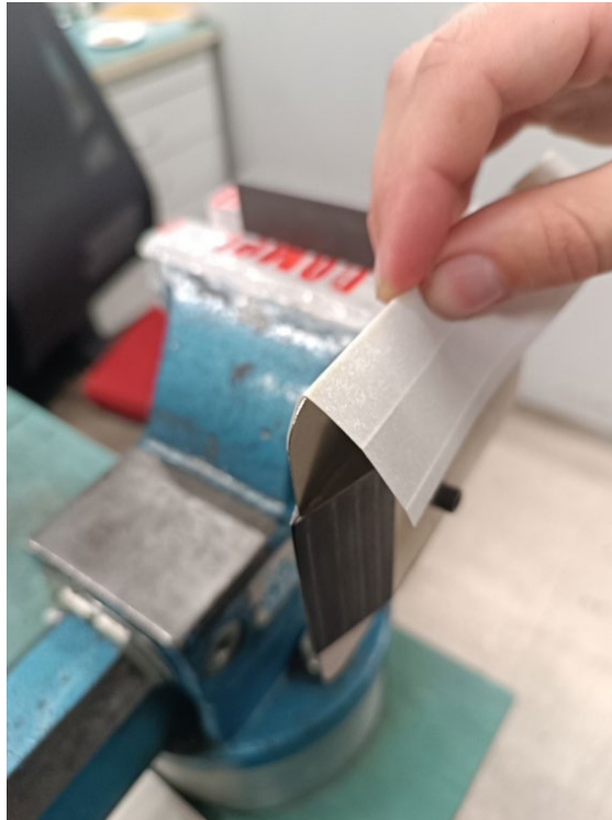
Slika 8: Prepogibanje izolacije (Lastni vir)
