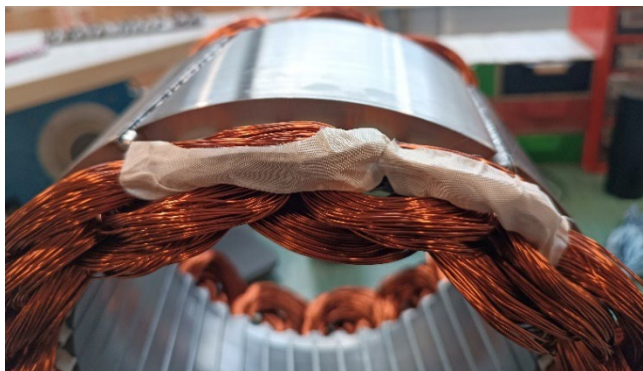
Slika 11: Izoliranje med fazami (Lastni vir)
