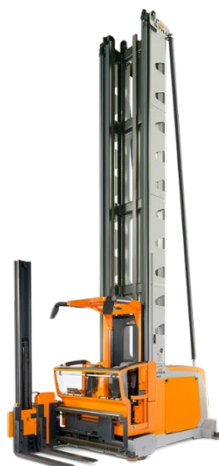
Slika 5: Visokoregalni viličar za vlaganje palet v visoke regale (Vir: Still, 2025)
