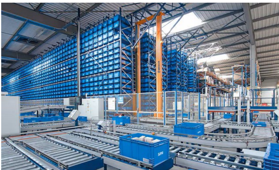
Slika 1: Avtomatizirani sistem za skladiščenje in iskanje škatel z regalnim dvigalom (Vir: Mecalux, 2023)
