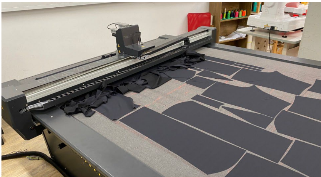
Slika 6: Primer avtomatskega krojenja (Vir: Avtomatsko krojenje, b. l.)
