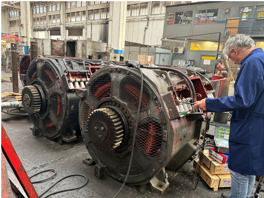
Slika 8: Vlečni motor lokomotive serije 363 – izvajanje meritev (Lastni vir)
