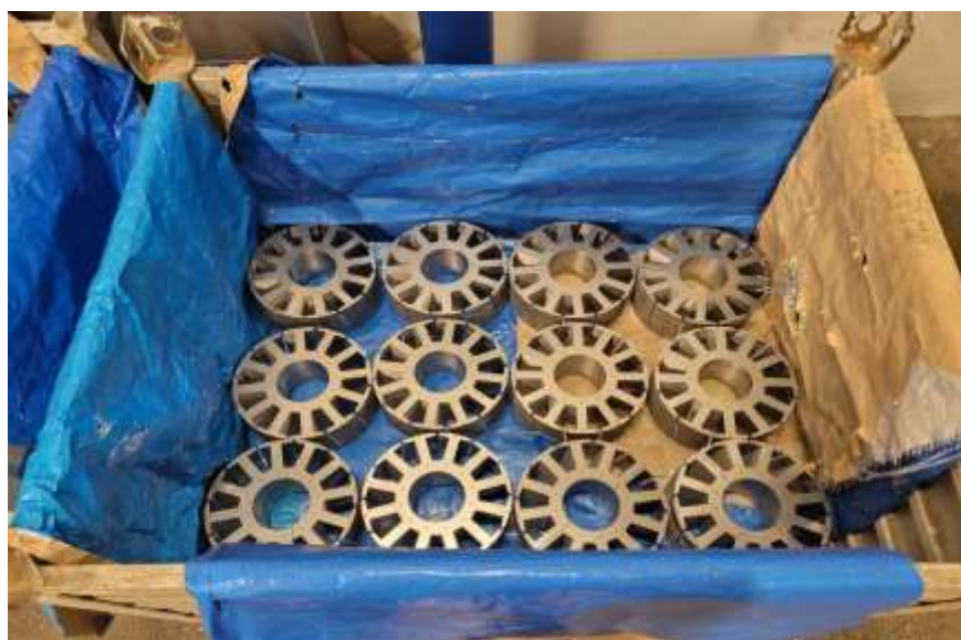
Slika 15: Zaboje s statorskimi paketi (Lastni vir)
