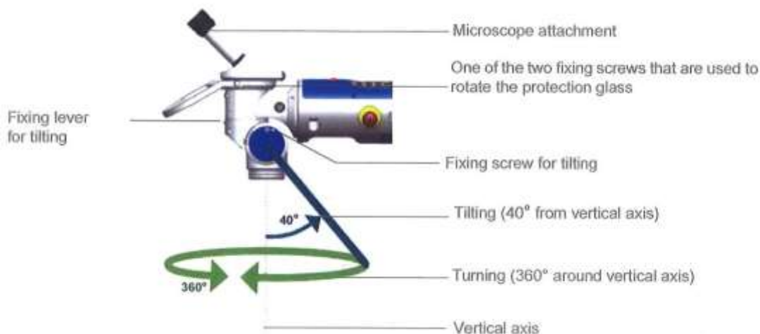
Slika 23: Cilj obračanja naklanjanja (Lastni vir)
