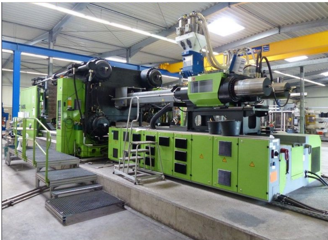
Slika 2: Brizgalni stroj Engel DUO 1700 (Vir: Maschinenhandel Borowski GmbH, b. I.)
