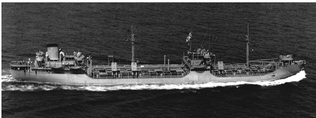
Slika 4: Prva kontejnerska tovarna ladja (SS Ideal X), predelana iz tankerja. (Vir: InBox Projects, 2020)
