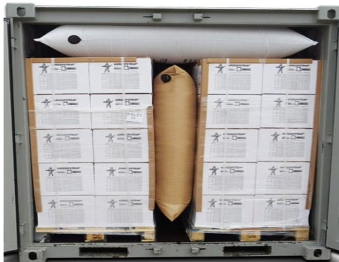
Slika 12: Zapolnjeni prostor v kontejnerju z napihljivima vrečama (Vir: Grönheit & Weigel Load Securing Systems, b. l.)
