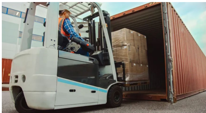
Slika 13: Nalaganje palet v kontejner z viličarjem (Vir: Transocean Equipment Management, LLC)
