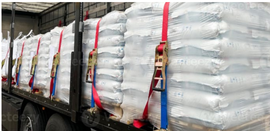
Slika 10: Privezani tovor z napenjalnimi trakovi (Vir: Vecteezy, b. l.)
