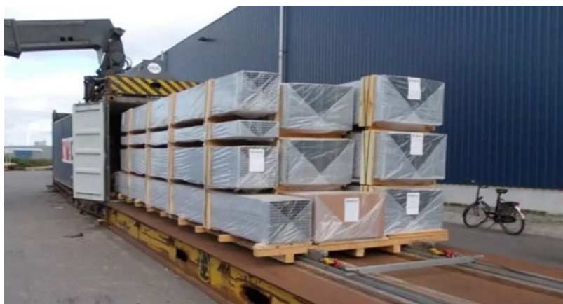
Slika 14: Nakladanje kontejnerja z valjčnimi tračnicami (Vir: Joloda Hydraroll, b. l.)
