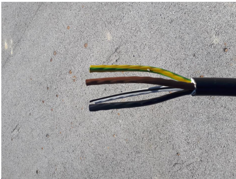
Slika 2: Barve vodnika (Vir: lasten)
