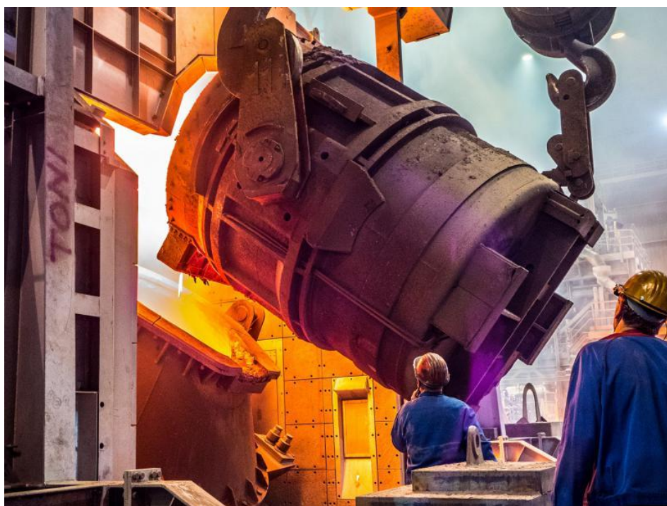
Slika 11: Vlivanje taline v konvertor AOD
