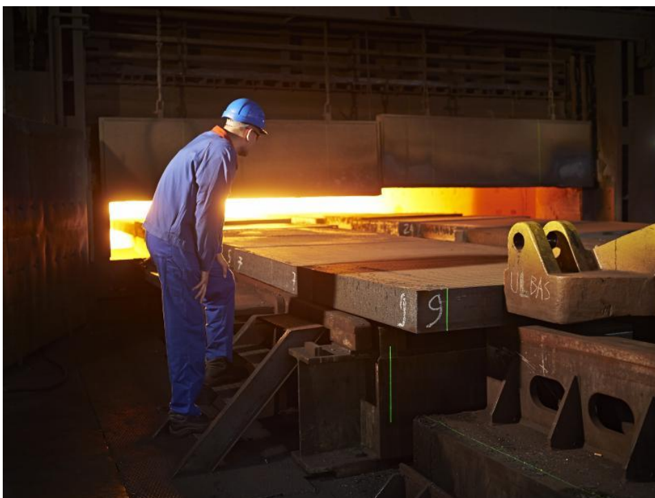
Slika 12: Zakladanje slabov v potisno peč
