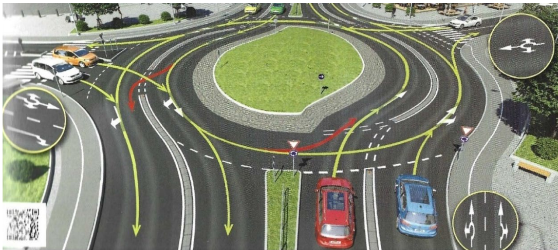
Slika 3: Krožišče s spiralnim potekom krožnega pasu (Vir: Breznik, P., 2022)
