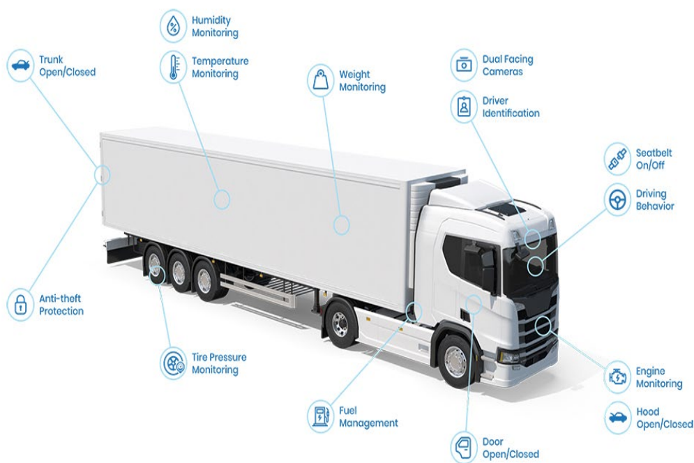
Slika 8: Prikaz storitev, ki jih omogoča telemetrija na tovornem vozilu (Vir: Telematics alliance, 2025)
