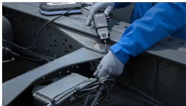
Slika 10: Priklop diagnostičnega orodja Jaltest na zavorni sistem EBS (Vir: Jaltest, 2025)
