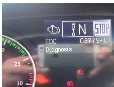
Slika 4: Prikaz DTC kode na armaturni plošči tovornega vozila MAN (Vir: Truck & Plant, 2025)
