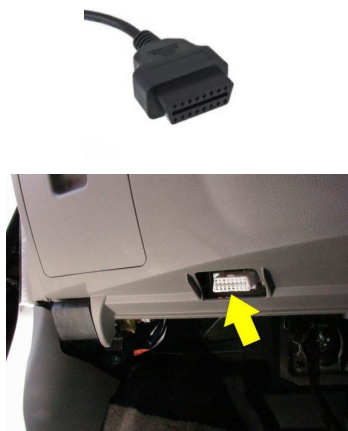
Slika 2: Priključek OBD II in lokacija priključka OBD II v vozilu (Vir: Geotab, 2025)
