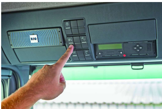
Slika 12: Prikaz vgrajenega vmesnika RIO Box (Vir: Reichel, 2021)
