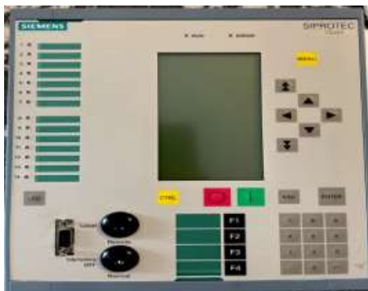
Slika 11: Zaščitni numerični rele (IED) Siemens, Siprotec 4, 7SJ632 (Lastni vir)
