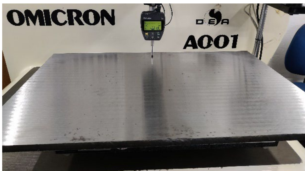
Slika 13: Merjenje ravnosti (Lastni vir)
