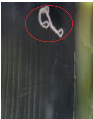
Slika 6: Tujki v termo krčljivi cevi (Vir: Interna dokumentacija Baur GmbH, 2019)
