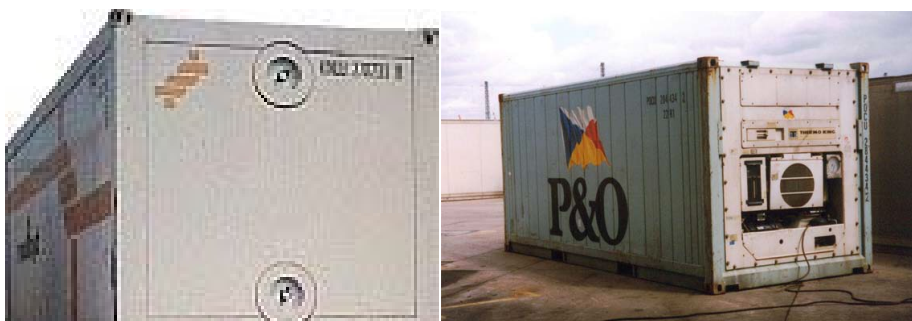
Slika 10: Primer izoliranega kontejnerja, ki se hladi preko hladilnega sistema ladje ali terminala in primer mehansko hlajenega kontejnerja (Vir: Germek, 2011)
