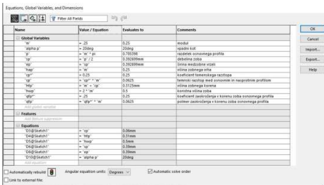
Slika 40: Enačbe v programu SW, zobnica (Lastni vir)
