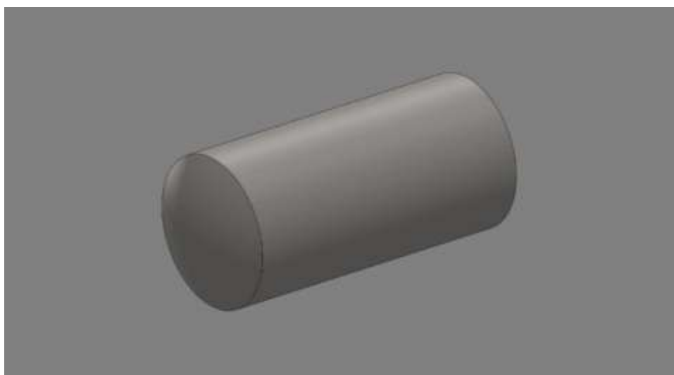
Slika 10: Cilindrični zatič DIN 7, dolžina 4 mm, 3D-model (Lastni vir)
