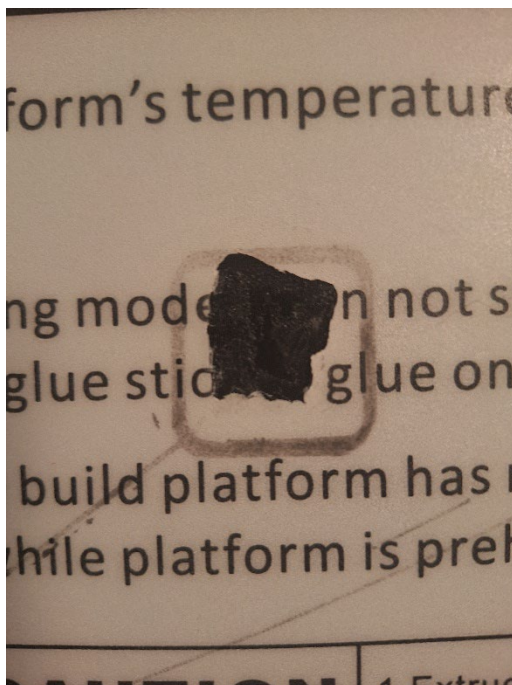
Slika 24: Slika defektne osnovne plošče (Lastni vir)
