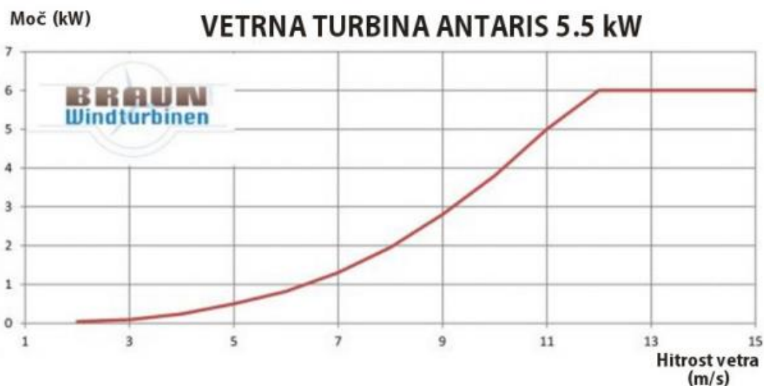
Slika 17: Obratovalna karakteristika turbine Antaris 5,5 kW
