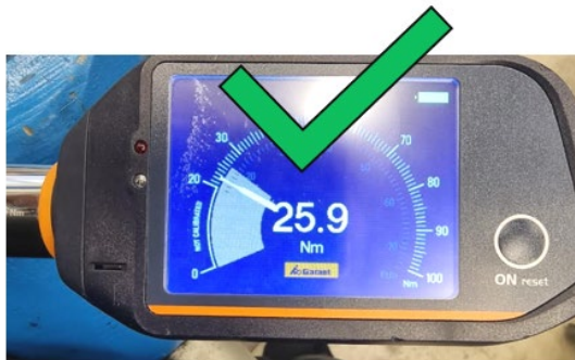
Slika 3: Primerna sila zategovanja v obsegu 23 Nm–max 26 Nm. (Lastni vir)
