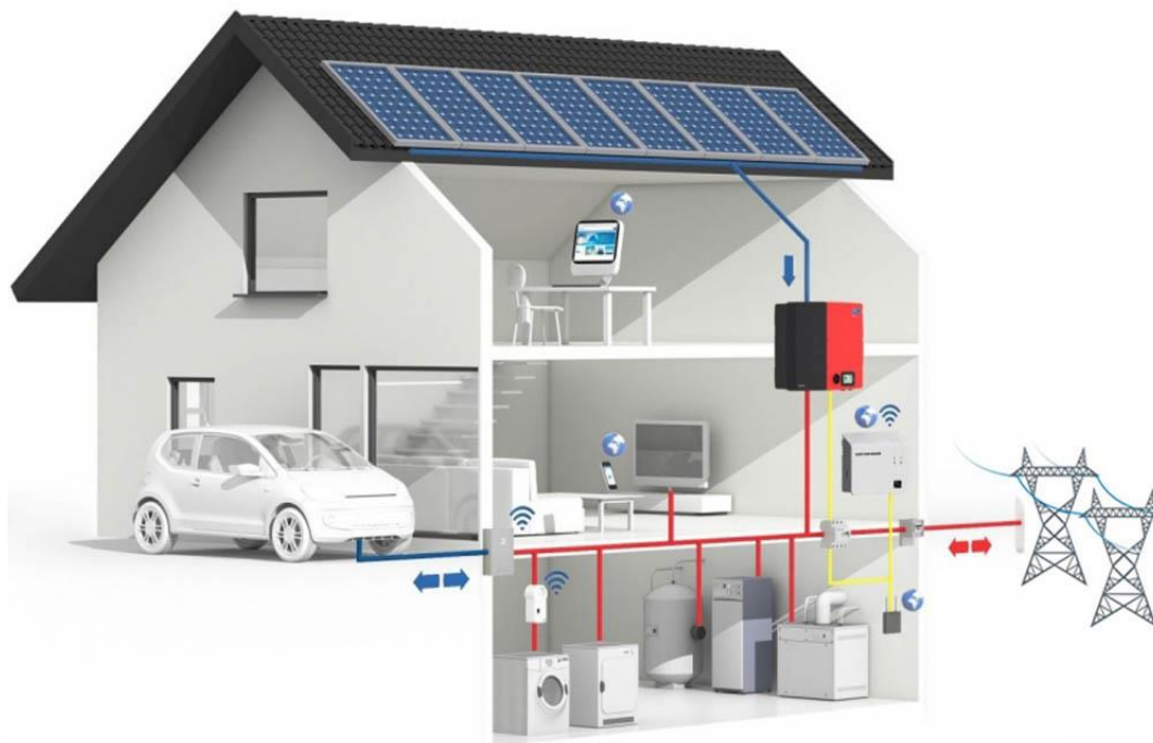
Slika 1: Shema delovanja sončne elektrarne (Vir: Ekart, 2023)
