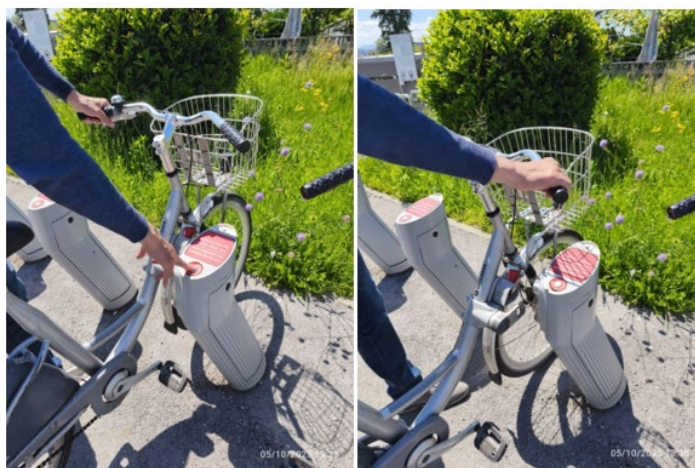
Slika 12: Izposoja mestnega kolesa BicikeLJ: 1. korak – odklepanje (pritisk na gumb) (levo) in 2. korak – avtomatski odklep ključavnice (izvlek kolesa) (Lastni vir)
