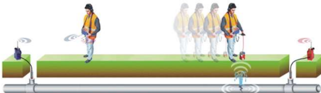
Slika 9: Iskanje puščanja s korelatorjem
