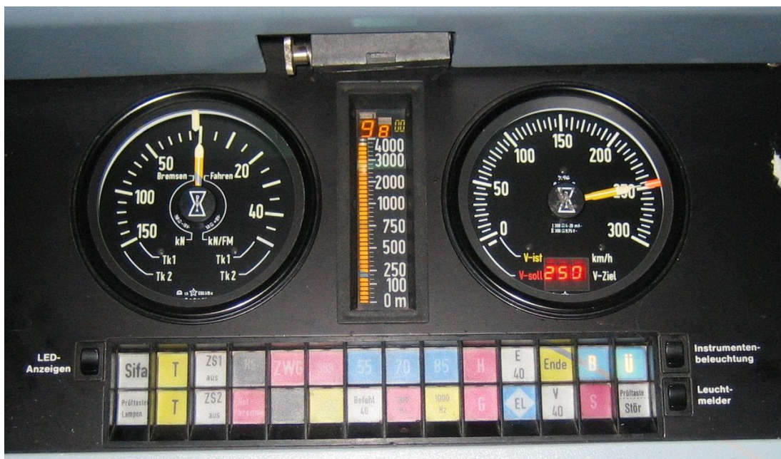
Slika 15: Signalizacija LZB na ICE 2 (Vir: Wikimedia, 2025)
