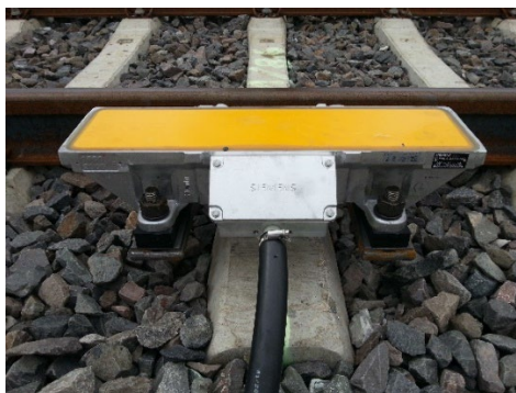
Slika 1: PZB magnet na infrastrukturi (Vir: Wikimedia, 2025)
