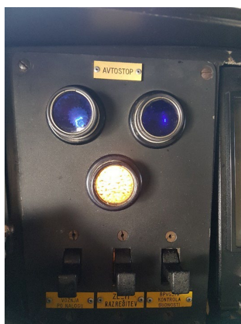
Slika 2: PZB 160 na seriji 363, v teku časovna kontrola hitrosti (Lastni vir)
