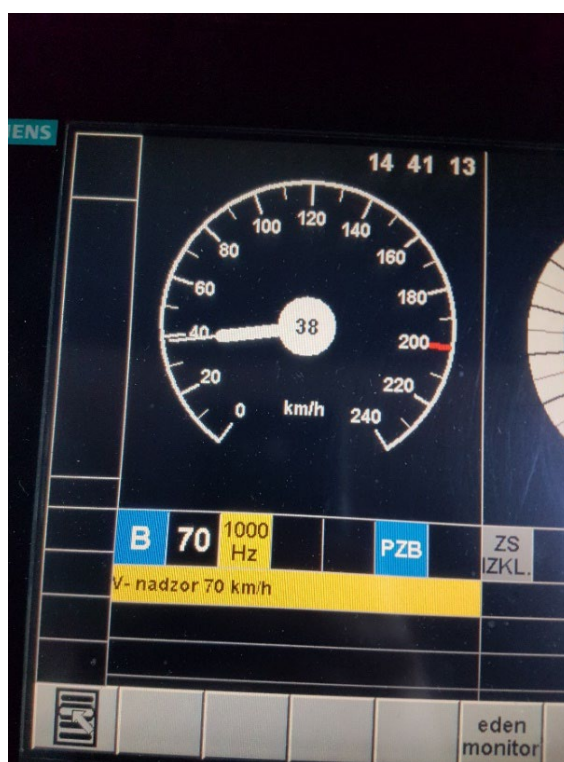
Slika 7: Aktiven vpliv 1000 Hz na 541/1216 (Lastni vir)
