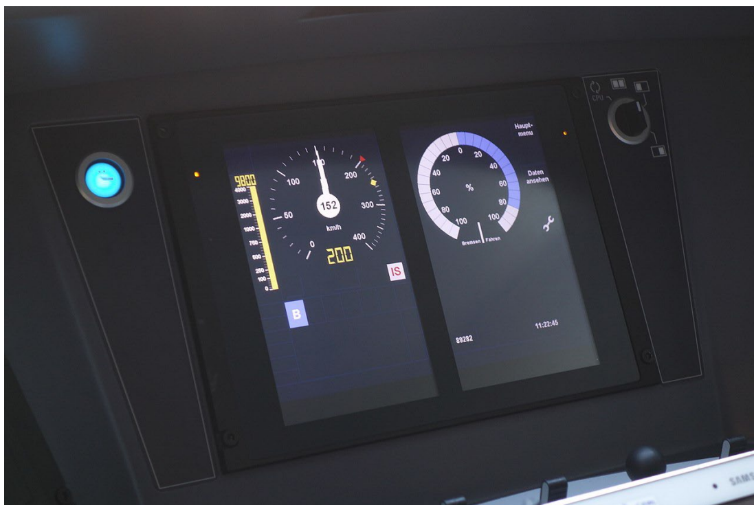
Slika 16: Prikaz LZB na vlaku ICE 4, s slike je razvidno, da je trenutna dovoljena hitrost 200 km/h in da bo takšna ostala še najmanj 9.800 m. (Vir: Wikimedia, 2025)
