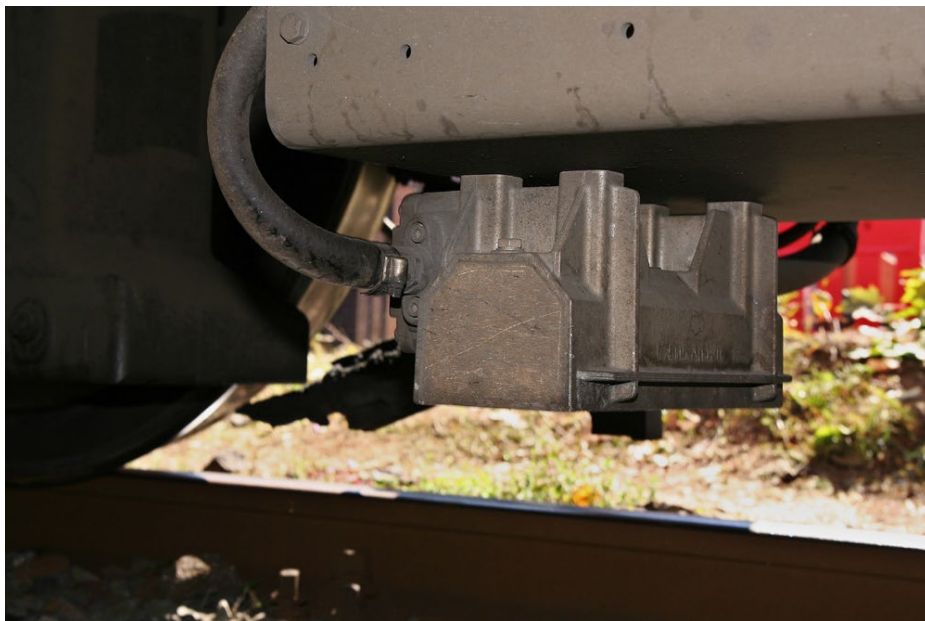
Slika 14: LZB sprejemnik nameščen na vozilu (Vir: Wikimedia, 2025)
