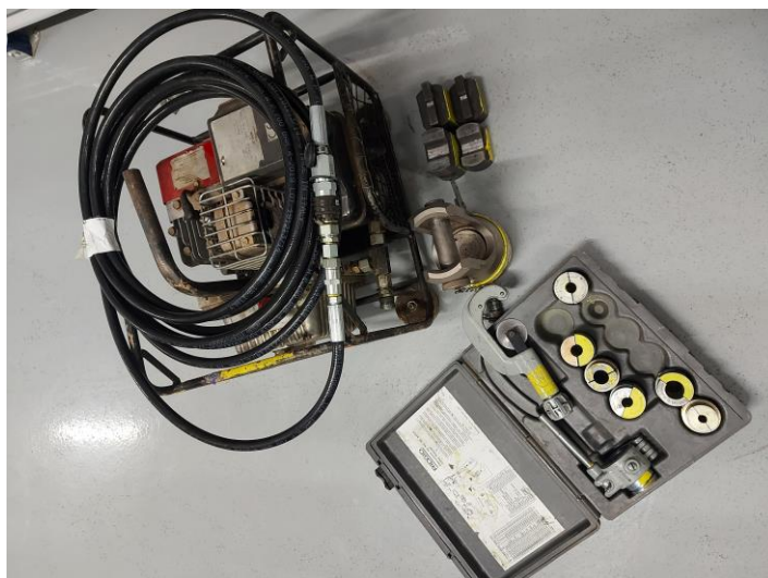
Slika 38: Hidravlična stiskalnica in orodje za stiskanje kompresijskih sponk (Lastni vir)
