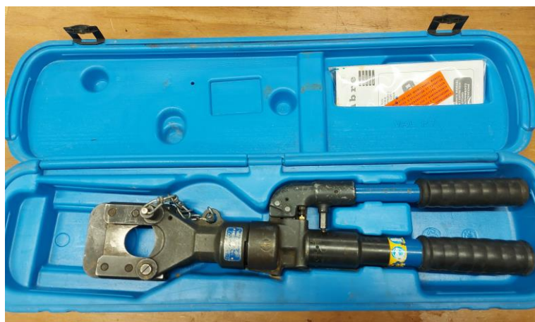
Slika 37: Hidravlične škarje HT-TC041 (Lastni vir)
