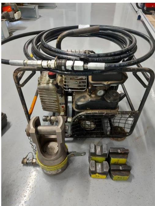
Slika 29: Hidravlična stiskalnica in orodje za stiskanje kompresijskih sponk (Lastni vir)
