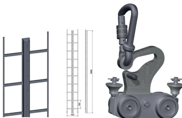
Slika 18: FVS in drsnik za varovanje (Vir: Endal katalog pdf, 2020)
