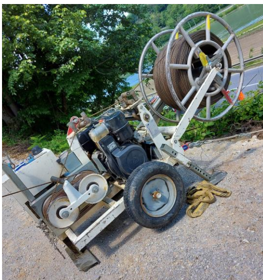
Slika 35: Vitel Tesmec Cantamessa (Lastni vir)
