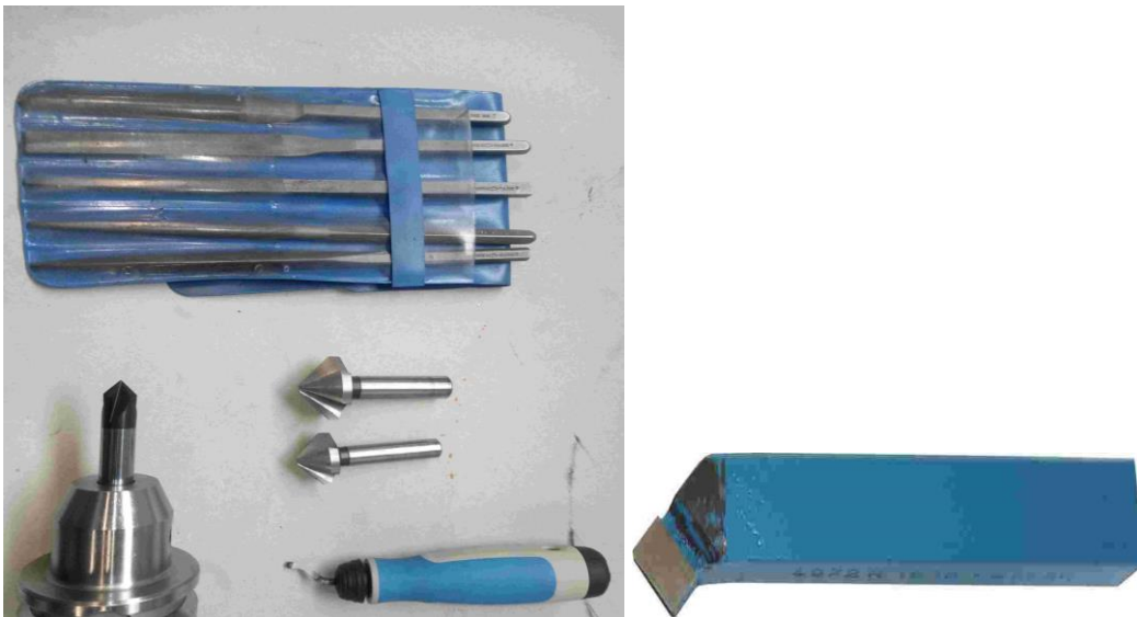
Slika 16: Različni pripomočki za strojno in ročno pobiranje robov. Stružni nož za 45-stopinjsko pobiranje robov (Lastni vir; wd-tehnik, 2022)
