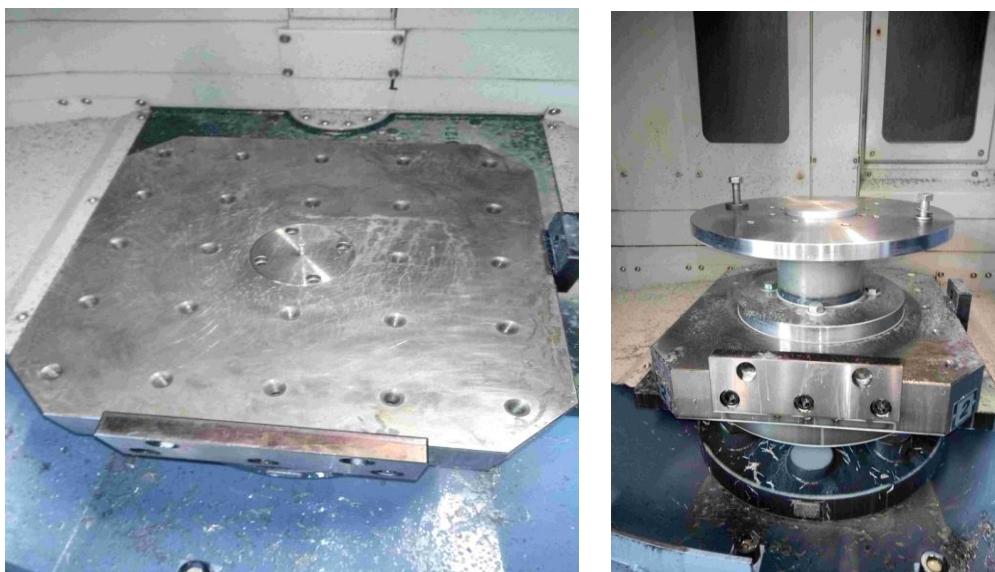
Slika13 : Vrtljiva miza za obdelavo in rezanje ter dodatni nastavek za cevi (Lastni vir)
