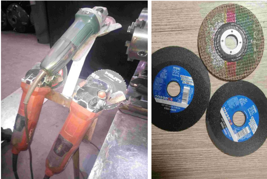
Slika 8 : Kotne brusilke in različni nastavki za obdelavo (Lastni vir)
