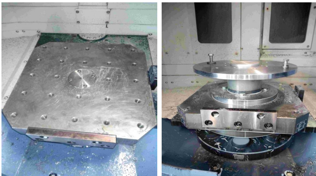
Slika 10: Obdelovalna miza na stroju brez in s podaljškom (Lastni vir)
