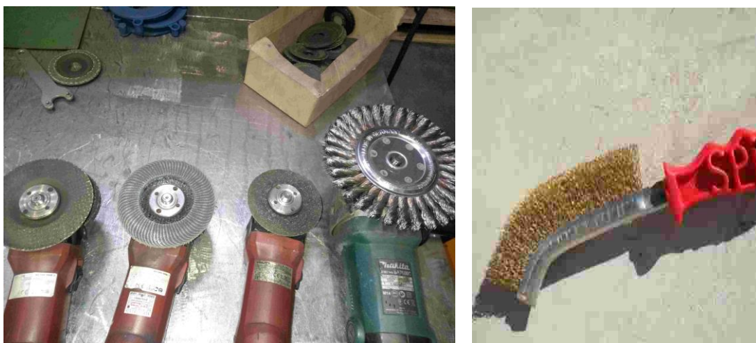
Slika 19 : Kotna brusilka z različnimi nastavki in žična krtača za ročno brušenje (Lastni vir)
