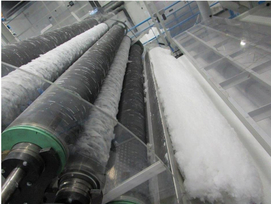
Slika 1: Zabitje mikalniških valjev z vlakni (Lastni vir)
