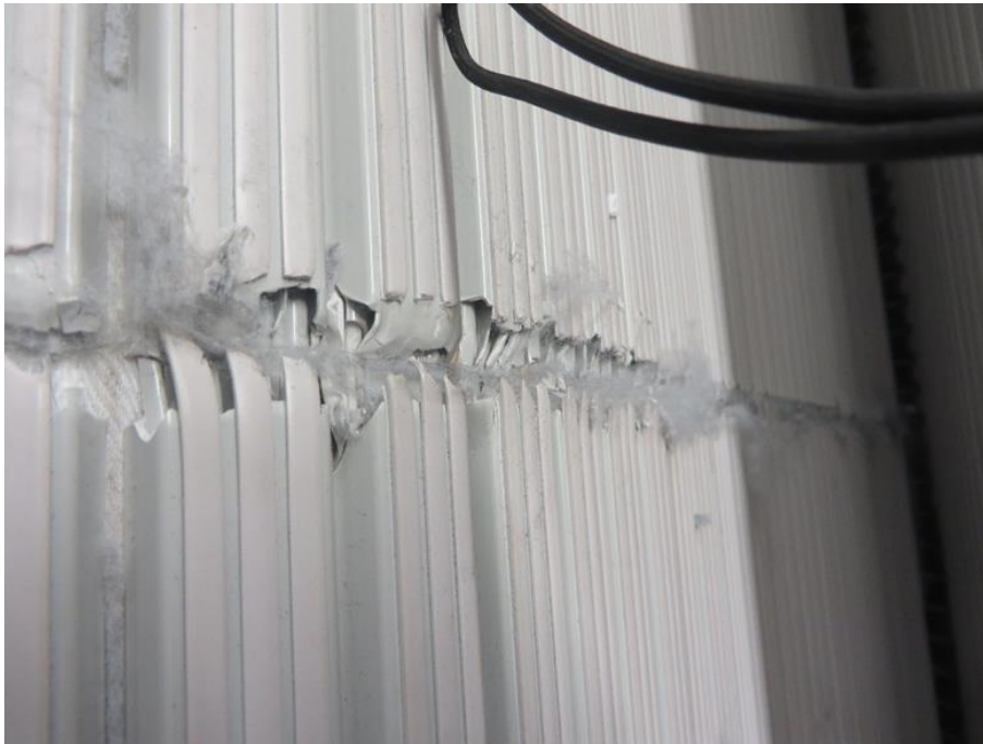
Slika 3: Pretrganje transportnega traku (Lastni vir)
