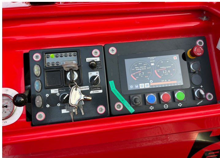
Slika 11: Prikaz nadzora nad vlečno silo pri strojnem polaganju SN KB (Lastni vir)
