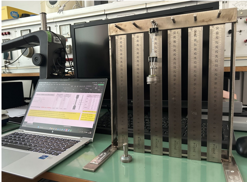
Slika 21: Izvedba nateznega preizkusa XLPE izolacije (Lastni vir)
