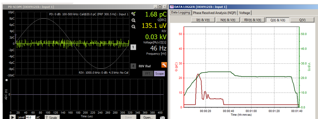
Slika 19: Izvedba meritev delnih razelektrenj glavne izolacije na EIMV (Vir: EIMV, 2025)
