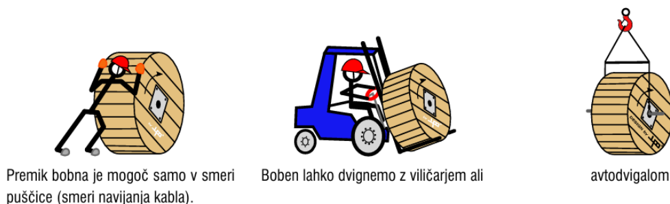
Slika 4: Primer transporta kabla (Vir: ELES T-3, 2024)
