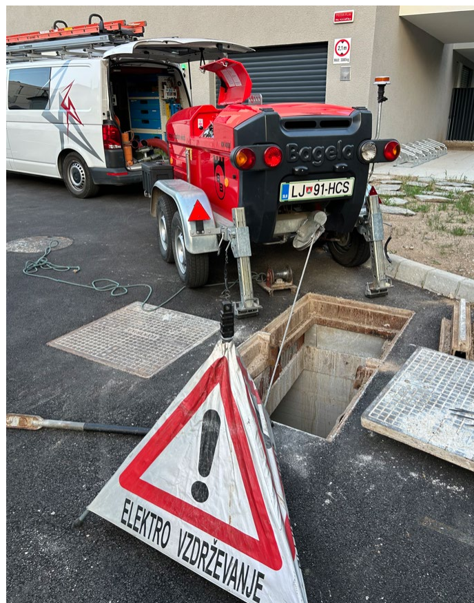
Slika 10: Vlečna naprava Bagela KW4000 za strojno polaganje kablov (Lastni vir)
