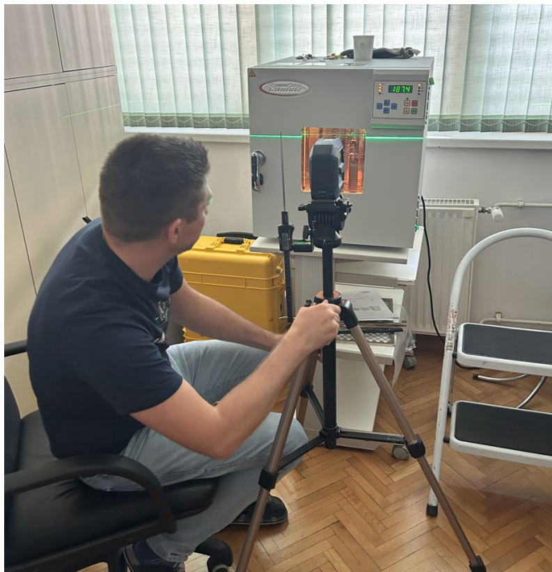
Slika 22: Odčitavanje raztezka XLPE izolacije (Lastni vir)
