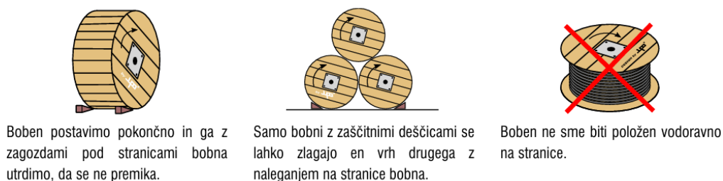
Slika 5: Primer skladiščenja kabla (Vir: ELES T-3, 2024)
