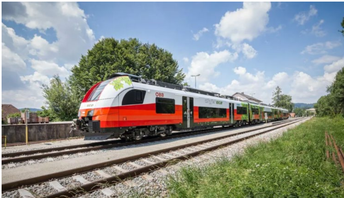
Slika 17: Cityjet Eco električno baterijski vlak na neelektrificirani progi (Vir: Zukunftsbahn, 2020)
