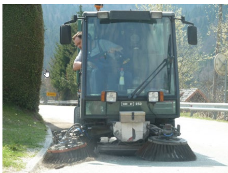
Slika 17: Pometanje koritnice s pometalno-sesalnim strojem (Vir: https://komunala-mezek.si/strojno-pometanje.html , 2024)
