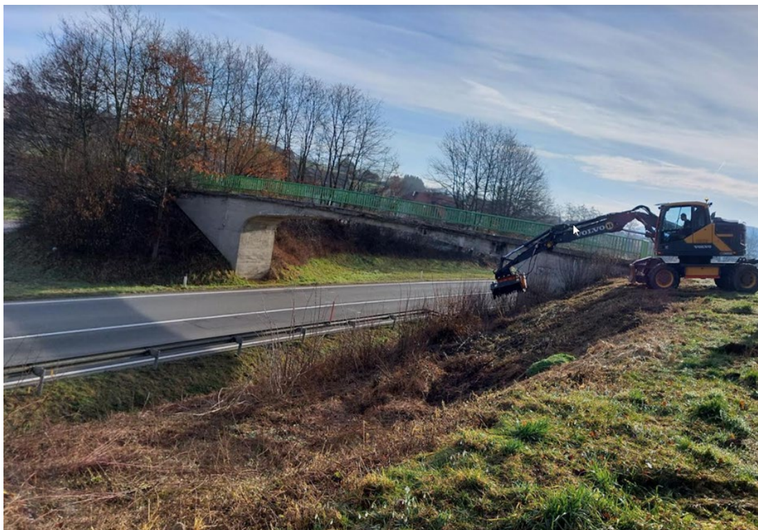
Slika 14: Gozdarski mulčer kot priključek na bagru s kolesi (Lastni vir)
