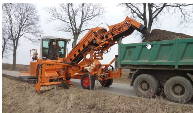
Slika 15: Pobiranje odvečnega materiala za nadaljnjo uporabo (Vir: https://www.svet-stroje.com/sl/freza-za-bankine-sbf-900 , 2024)
