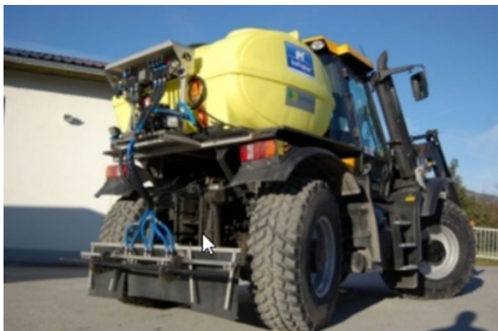
Slika 37: Sistem za pršenje slanice (Vir: http://www.komteh.si/eco_ice_fighter.htm , 2024)
