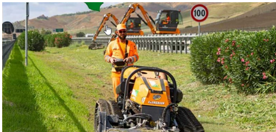
Slika 10: Samohodni mulčerji na kolesih in gosenicah
