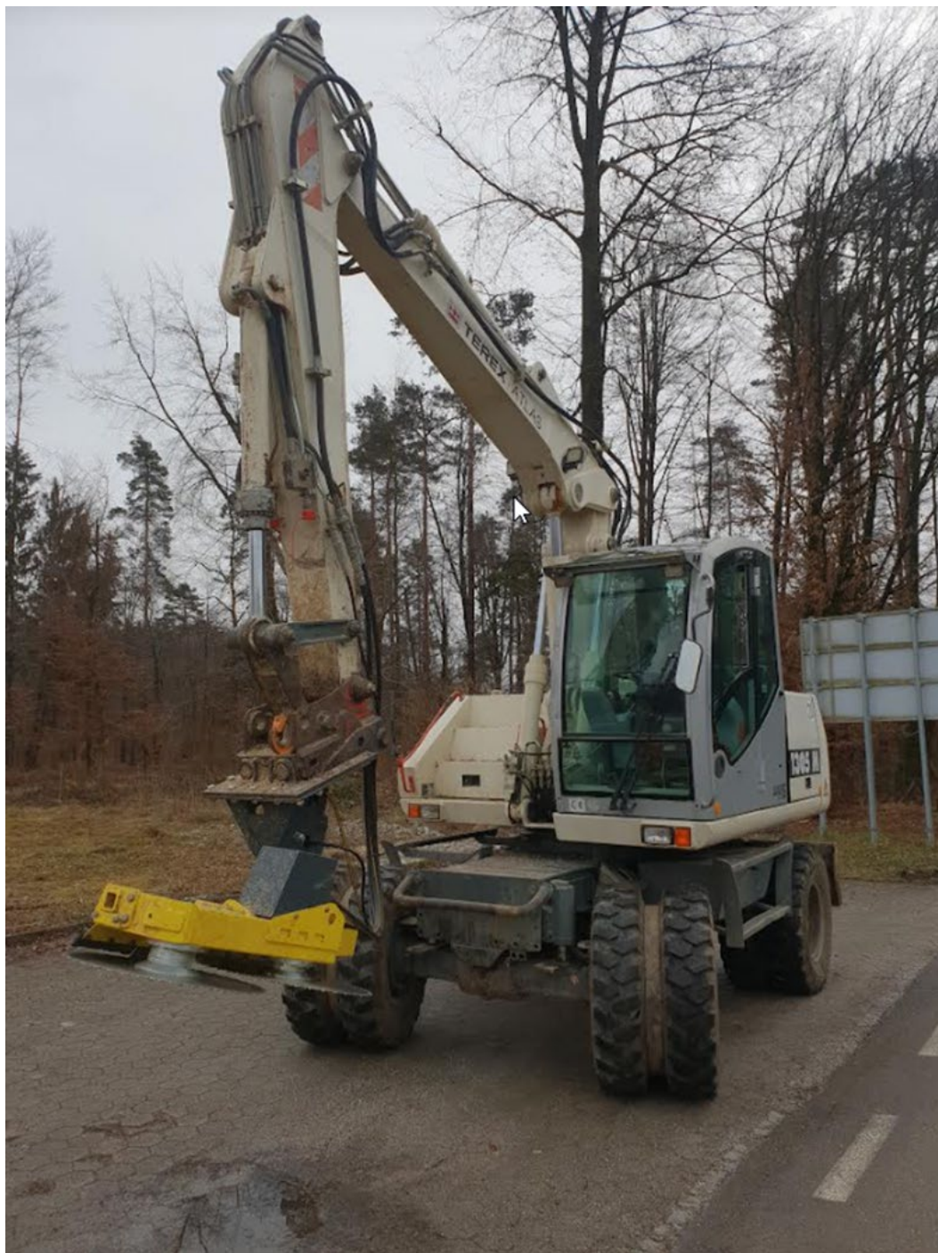
Slika 13: Žage za obžagovanje kot priključek na bagru s kolesi (Lastni vir)
