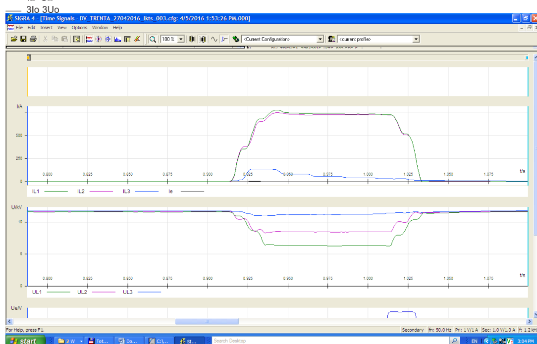
Slika 17: Oscilogram okvare na DV Trenta
