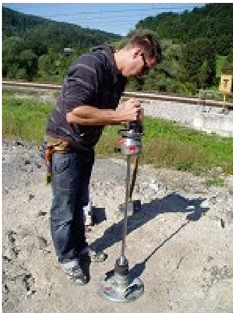
Slika 2: Meritve z dinamično ploščo (Vir: Lastni)
