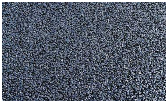
Slika 22: Videz površine iz gumirane asfaltne zmesi po suhem postopku (Vir: CTS, 2024)
