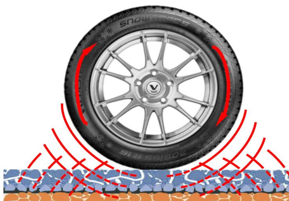
Slika 11: Absorpcija in odboj hrupa (Vir: lasten)
