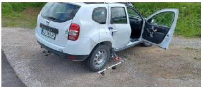
Slika 1: Slika sistema CPX, mikrofoni ob pnevmatiki (Foto-archiv ZAG: 046799d-06):
