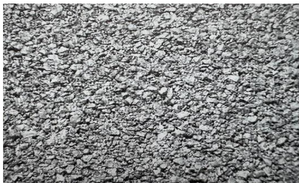
Slika 20: Vozna površina drenažnega asfalta PA 11 (Vir: Henigman, 2016)
