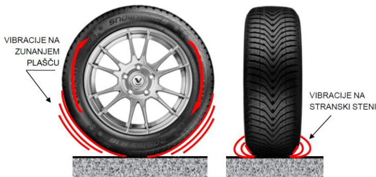
Slika 5: Nastanek vibracij na zunanjem plašču in stranski steni (Vir: lasten)
