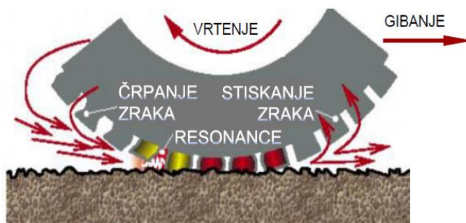
Slika 6: Črpanje zraka iz kanalov pnevmatike (Vir: Hribar, 2006)
