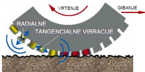
Slika 4: Nastanek radialnih in tangencialnih vibracij (Vir: Hribar, 2006)
