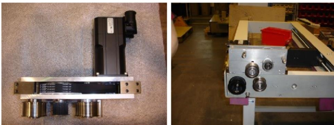
Slika 20: Pogonska enota pred in po namestitvi novega pogona (Lastni vir)
