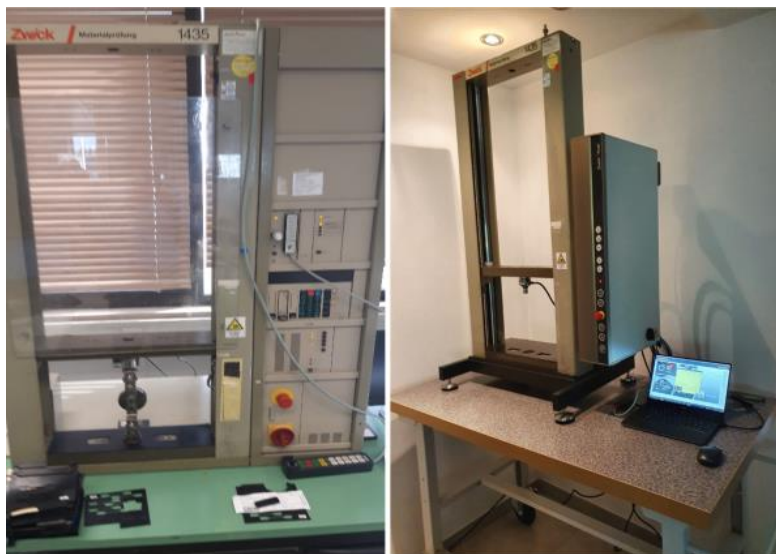
Slika 33: Naš Zwick pred modernizacijo in po njej (Lastni vir)
