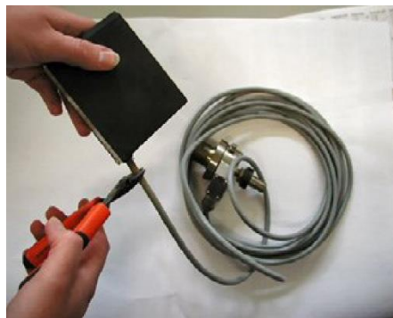
Slika 24: Prilagoditev obstoječe merilne celice (Lastni vir)
