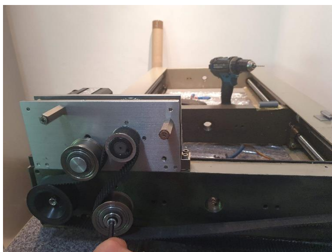
Slika 21: Namestitev novega jermena (Lastni vir)
