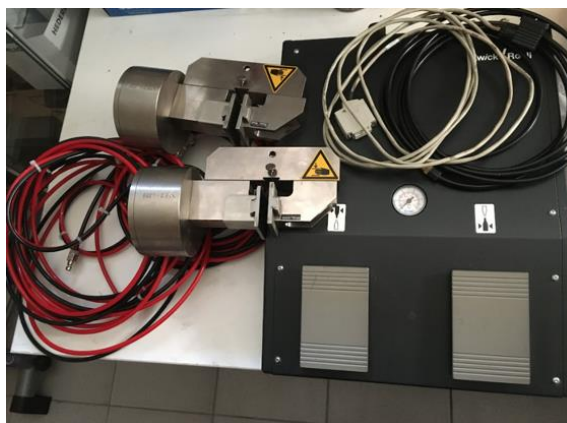
Slika 29: Nova pnevmatska vpenjala (Lastni vir)
