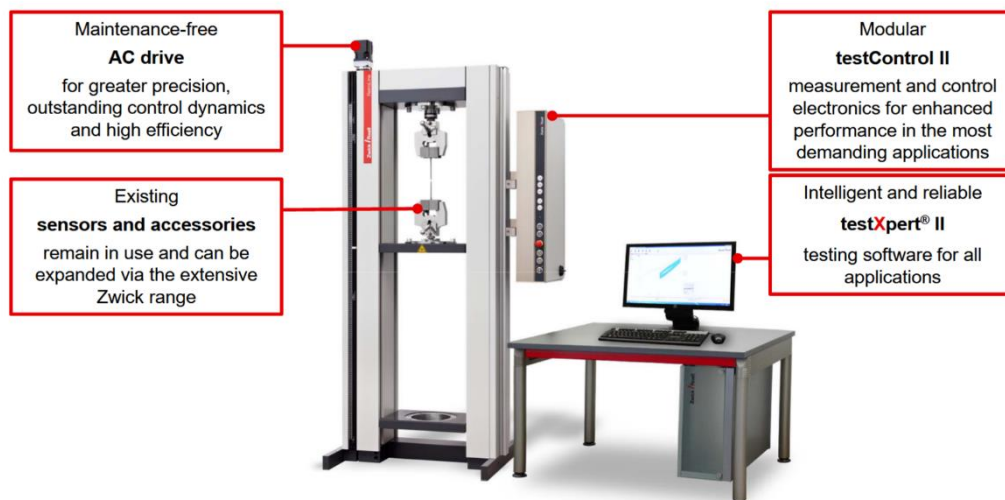
Slika 4: Osnovni koncept modernizacije stroja ZwickRoell (Vir: ZwickRoell GmbH & Co. KG, 2022)
