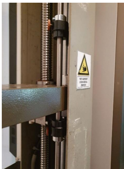
Slika 23: Namestitev mehanskih varnostnih omejevalcev na vodila (Lastni vir)
