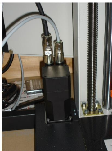
Slika 25: Povezava nove kontrolne elektronike tC z novim motorjem AC (Lastni vir)
