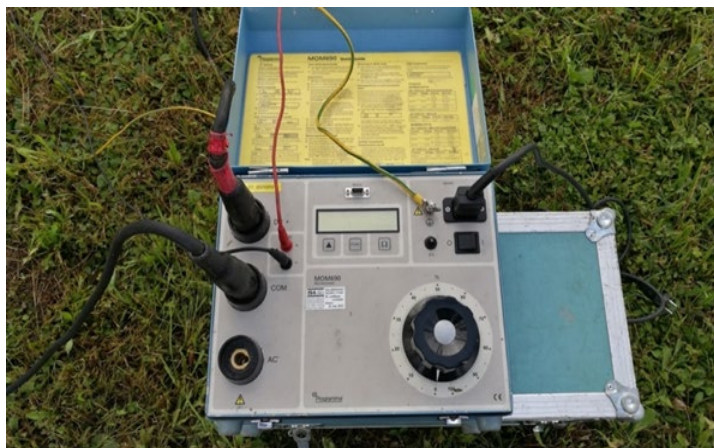
Slika 25: Instrument za merjenje padcev napetosti na ločilnikih in odklopnikih (Lastni vir)
