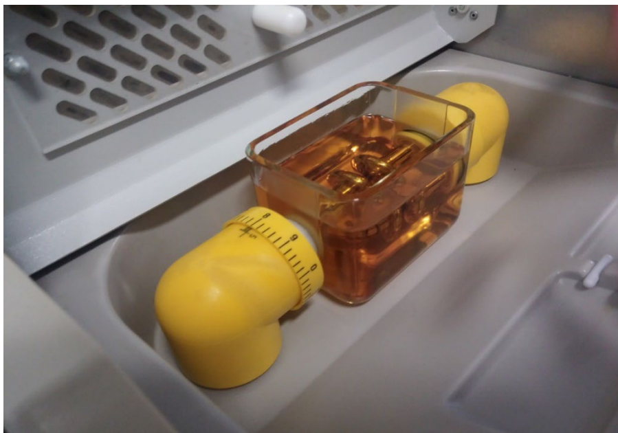
Slika 30: Merjenje izolacijske trdnosti (Vir: Špenko, 2016)
