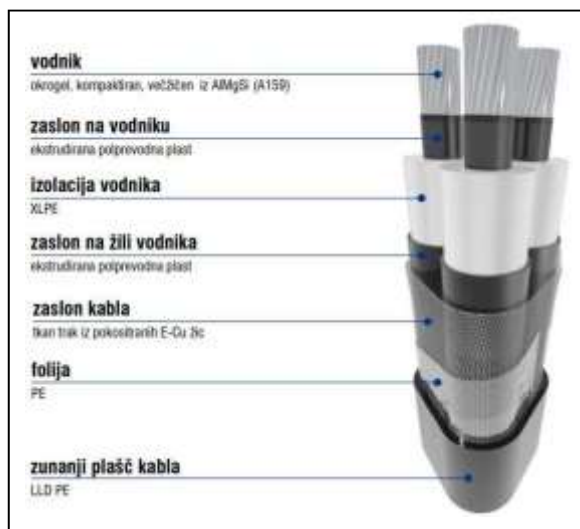
Slika 9: Sestava univerzalnega kabla s samonosilnimi vodniki.
