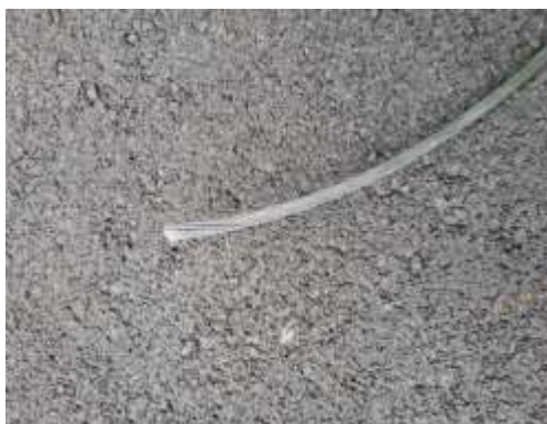
Slika 7: Vodnik AL-FE preseka 70 \text{ mm}^2 (Lastni vir)
