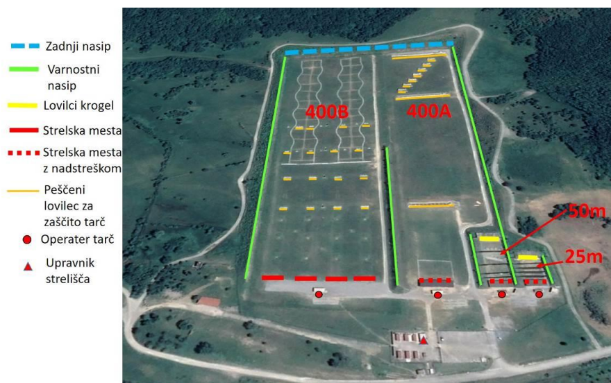
Slika 23: Ključna infrastruktura strelišča Mlake
