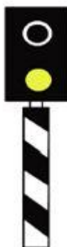
Slika 11: Signalni znak 56: Ustavitev pred nivojskih prehodom VIR: Signalni pravilnik, Ur. list RS, št. 123/2007 z dne 28. 12. 2007
