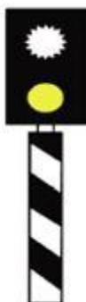
Slika 10: Signalni znak 55: Zavarovanje na nivojskem prehodu vključeno VIR: Signalni pravilnik, Ur. list RS, št. 123/2007 z dne 28. 12. 2007
