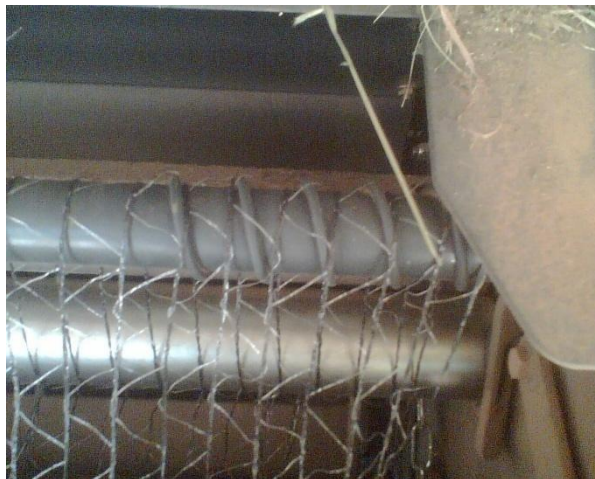
Slika 19: Prikaz delovanja balirke, ko razširi mrežico (lasten vir)
