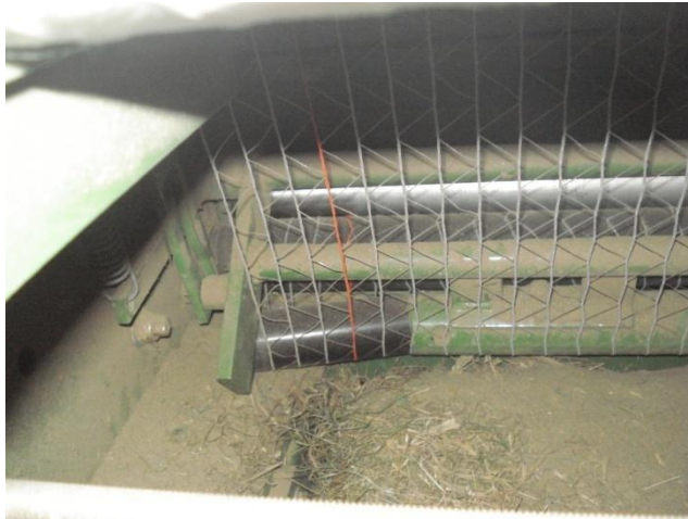
Slika 18: Prikaz delovanja balirke, ko razširi mrežico (lasten vir)
