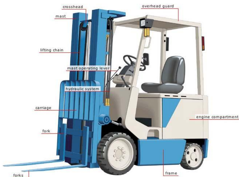
Slika 7: Teleskopski viličar na električni pogon. Vir: www.google.si , slike viličar.
