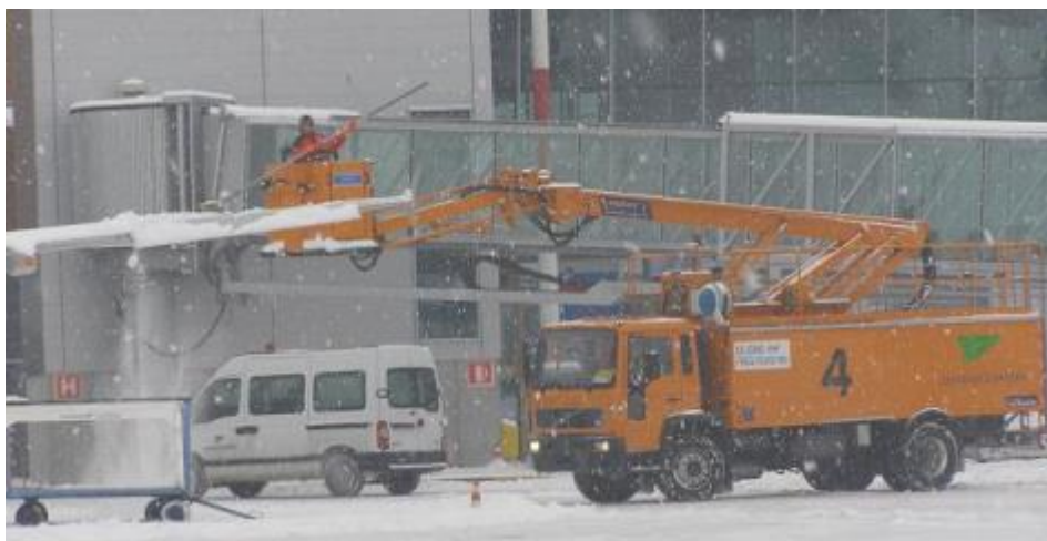
Slika 10: Ročno odstranjevanje snega s krila zrakoplova (Vir: lastni)
