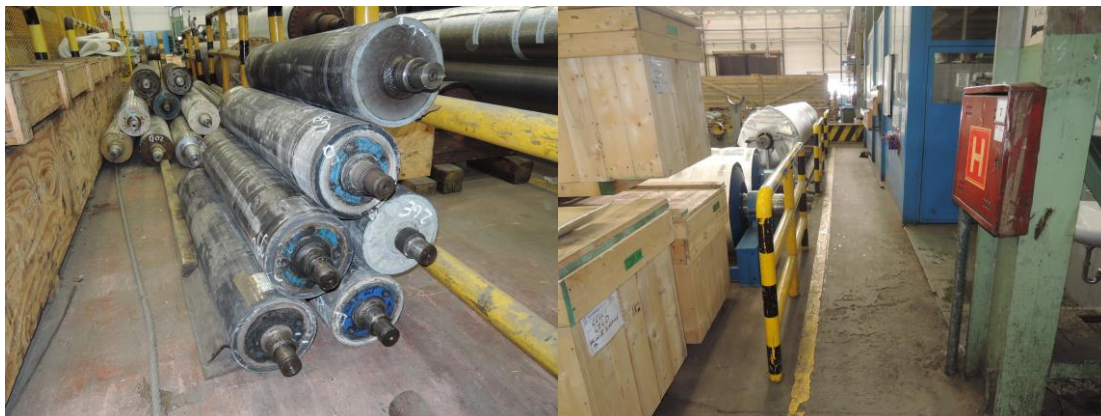
Slika 30: Varnostna varovalna ograja z zadrževanjem valjev pred porušitvijo (Vir: SchäferRolls, d.o.o.)
