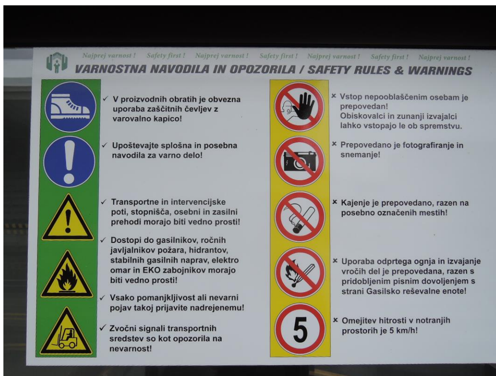
Slika 9: Primer namestitve varnostnih navodil in opozoril pred vhodom v proizvodne prostore in skladišča (Vir: SchäferRolls, d.o.o.)
