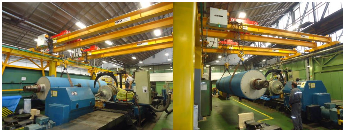
Slika 23: Sinhronizirano delovanje dveh dvojnih konzolnih dvigal med transportom valja za potrebe papirne industrije s težo 18,5 ton (Vir: SchäferRolls, d.o.o.)
