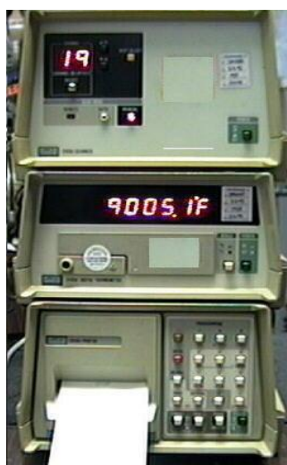
Slika 3: Oprema za merjenje temperature vozil za prevoz pokvarljivih živil
