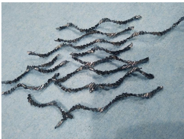
Slika 14: Pokazatelj obremenitve delovnega vretena (Vir: lasten)
