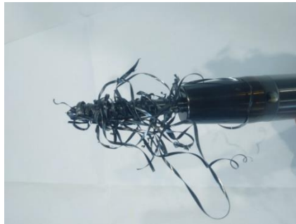
Slika 5: Odrezki, nevarni za obdelovanca, orodje in strojne komponente (Vir: lasten)
