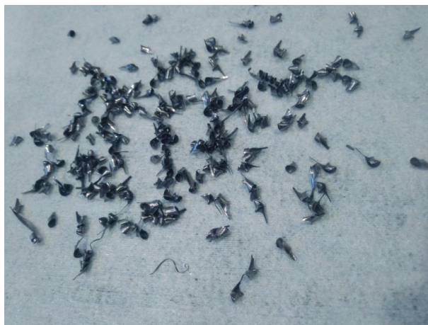
Slika 6: Tvorjenje odrezkov pri optimalnih parametrih za material C (Vir: lasten)
