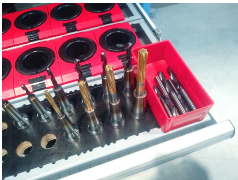
Slika 14: Ustrezna hramba orodij (Vir: lasten)
