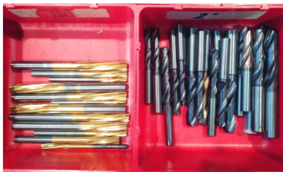
Slika 13: Neustrezna hramba orodij (Vir: lasten)
