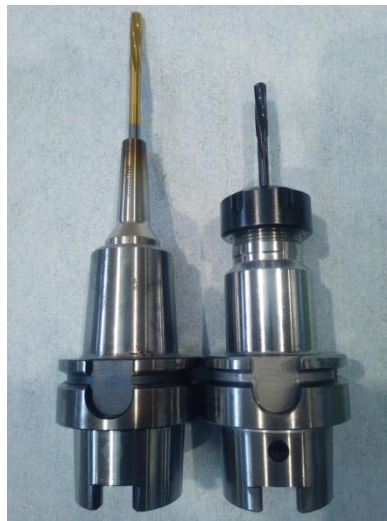
Slika 10: Primerjava velikosti Slimline (levo) in stročnice (desno) (Vir: lasten)
