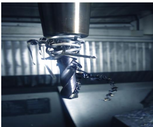
Slika 10: Hitra obraba orodja (Vir: lasten)
