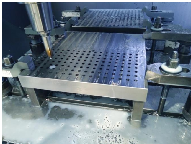
Slika 11: Lom orodja zaradi nepravilnih parametrov (Vir: lasten)
