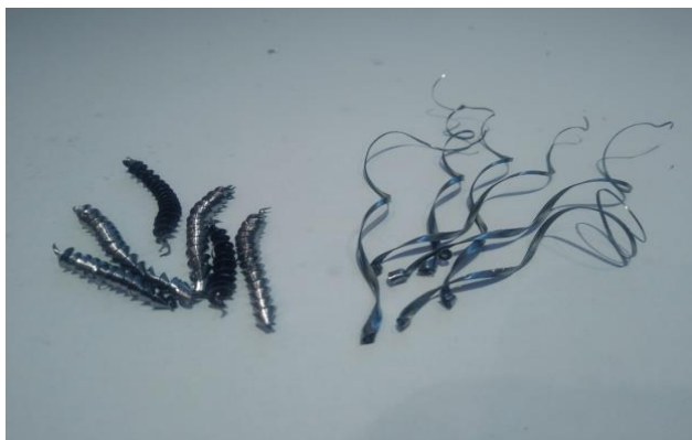
Slika 8: Razlika med vstopnim (levo) in izstopnim (desno) odrezkom (Vir: lasten)
