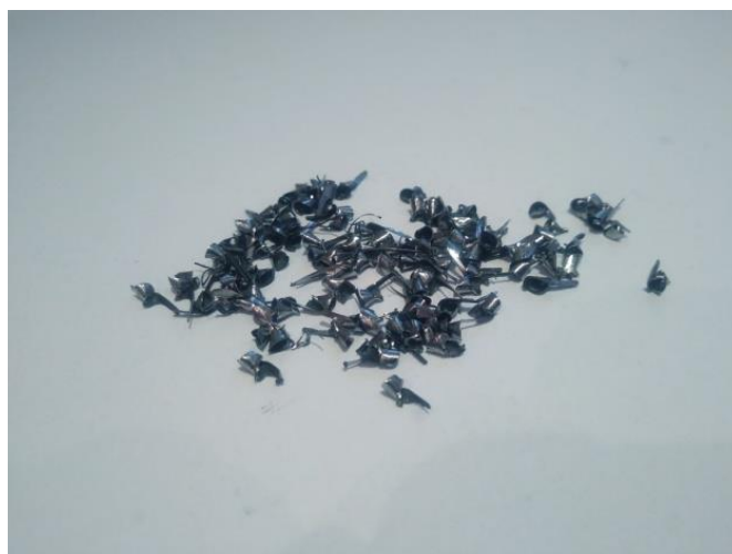
Slika 13: Tvorjenje odrezkov pri optimalnih parametrih za material B (Vir: lasten)
