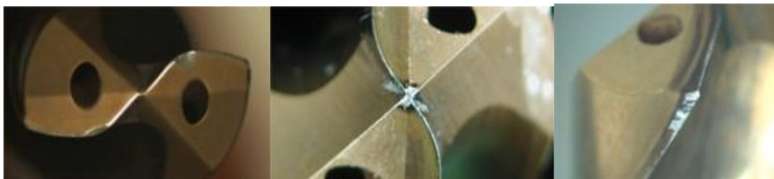
Slika 7: Tipične obrabe svedrov (Vir: Sandvikcormant.com, 2019)
