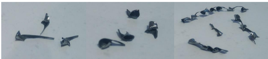
Slika 7: Razlike pri odrezkih zaradi delovnega pomika (Vir: lasten)
