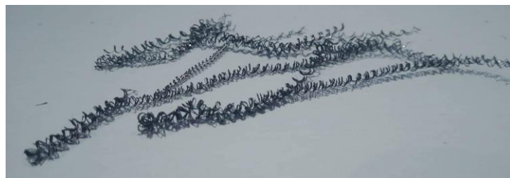
Slika 12: Tvorjenje odrezkov pri povrtavanju s povrtalom C (Vir: lasten)
