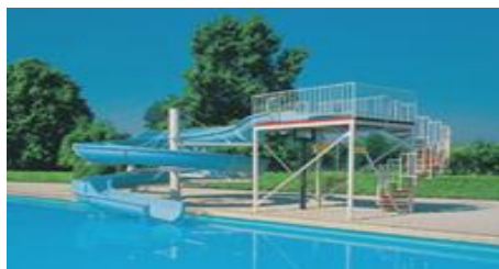
Slika 1: Tobogan: poliestri + gelcoat
