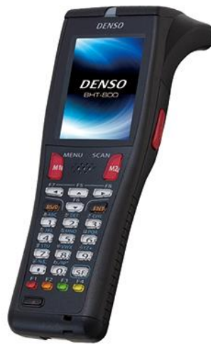
Slika 3: Optični čitalnik, kakršni se uporabljajo v skladišču za komisioniranje (Vir: Denso Wave, 2019.)
