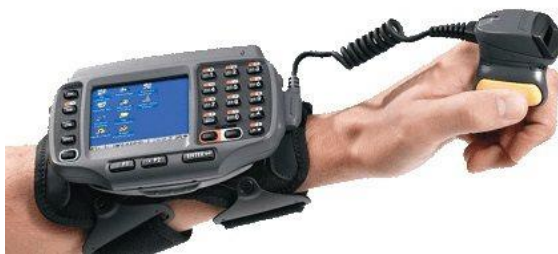
Slika 17: Primer optičnega čitalnika, privezanega na roko (Vir: Barcode Enterprises, 2018.)
