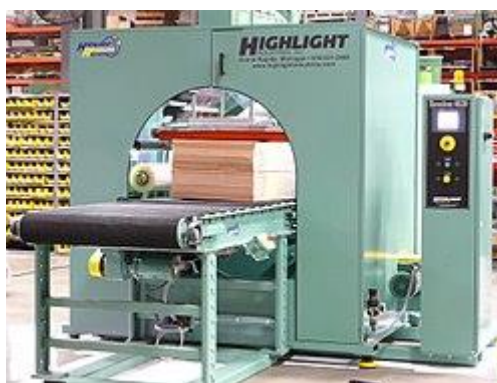
Slika 16: Primer samodejnega orbitalnega ovijalca palet (Vir: Wikimedia Commons (Imsquare22), 2010b.)
