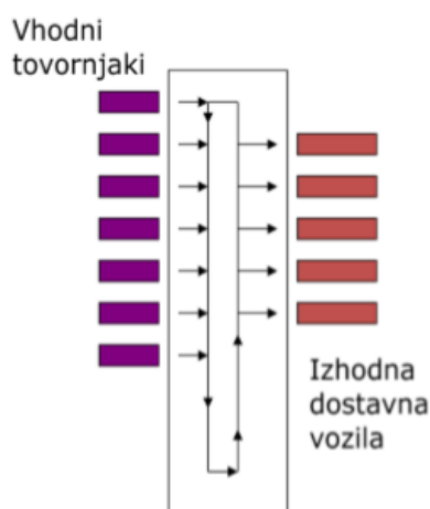
Slika 5: Shematski prikaz gibanja blaga v tipičnem pretočnem skladišču (Vir: Poljanec, 2011.)
