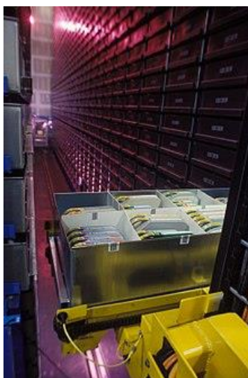
Slika 24: Sistem za samodejno skladiščenje blaga »fiksni prehod« (Vir: Wikimedia Commons (Lance Cheung), 2003.)
