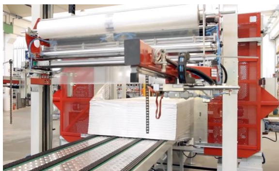
Slika 15: Primer samodejnega navpičnega ovijalca palet (Vir: YouTube (Messersi Packaging), 2017.)
