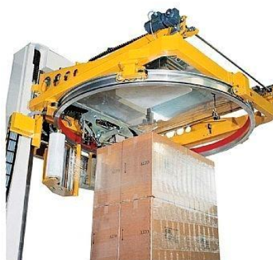
Slika 14: Primer samodejnega ovijalca palet z rotirajočim obročem (Vir: Direct Industry, 2019.)
