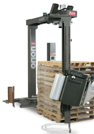
Slika 13: Primer polsamodejnega ovijalca palet z rotirajočo roko (Vir: Colony Packaging & Machine, 2017b.)
