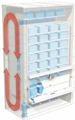
Slika 26: Način delovanja navpičnega vrtljaka (Vir: Pacific Integrated Handling, 2015.)
