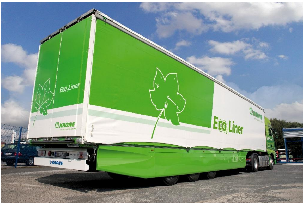
Slika 10: Aerodinamični dodatki na spodnjem delu prikolice za zmanjšanje zračnega upora kompozicije (KRONE, 2010)
