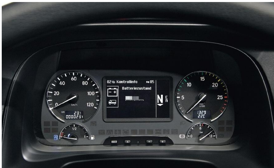
Slika 4: Zeleno, rumeno in rdeče polje na prikazovalniku vrtljajev motorja, tretja generacija vozil Mercedes-Benz Actros MIII (na trgu od leta 2008)
