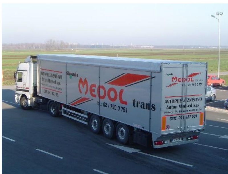
Slika 16: Nenaložena polprikolica s pomičnim dnom in pokrito ponjavo na vrhu
