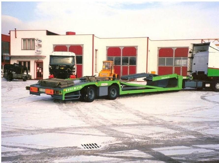
Slika 14: Vodljiva zadnja os na polpriklopniku (Hödlmayr, 1999)
