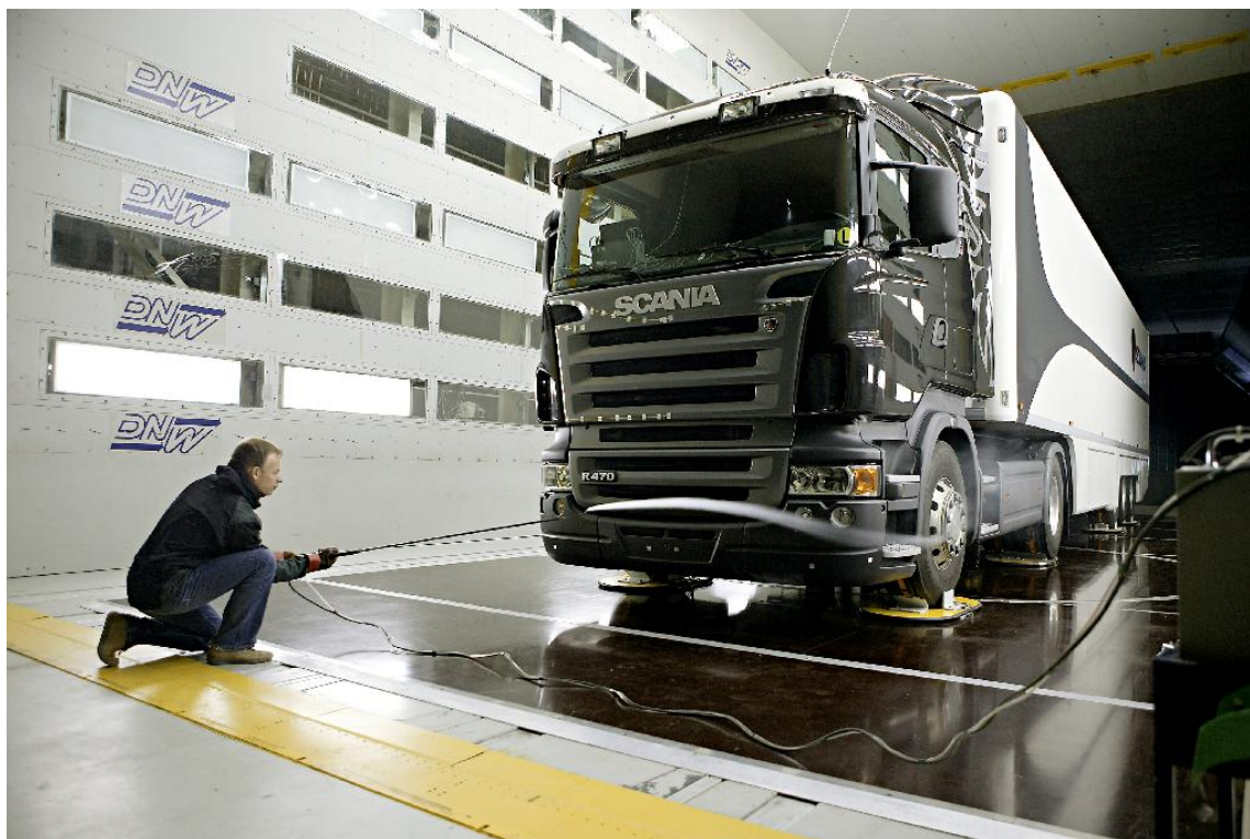
Slika 11: Preizkušanje ustreznosti aerodinamike vozila s polpriklonikom v vetrovniku (Scania, 2005)
