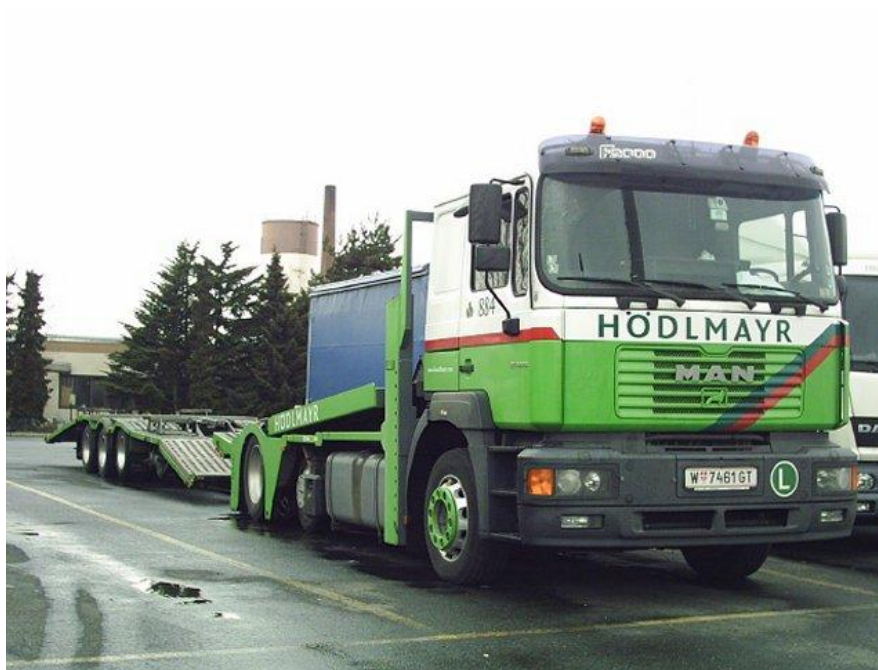
Slika 13: Tovorno vozilo z drugo dvížno osjo in priklopnikom s prvo dvížno osjo (Hödlmayr, 2005)
