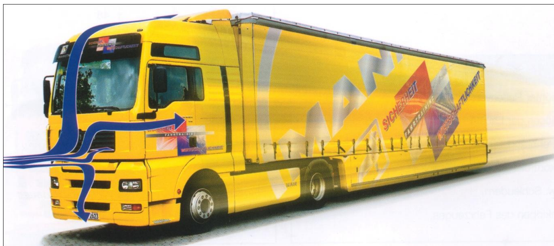
Slika 9: Porazdelitev sil zračnega upora, ki potekajo preko čelne ploskve vozila (MAN Nutzfahrzeuge GmbH, 2007)
