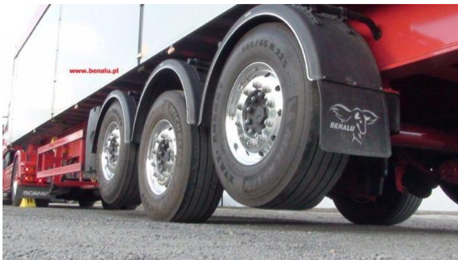
Slika 12: Polpriklopnik z dvema dvížnima osema (Benalu, 2010)
