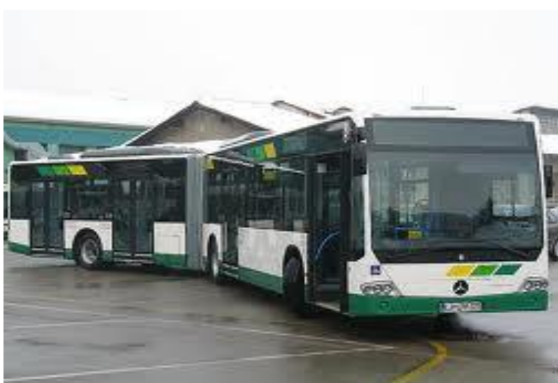
Slika 7: Nizkopodni avtobus (2010) (vir: arhiv LPP)
